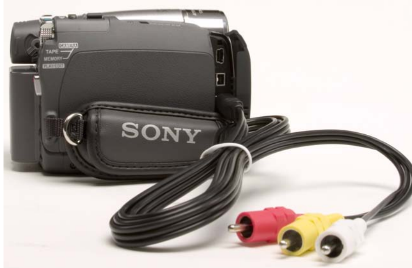
Figure 3. Connect the RCA Cable to AV Out
